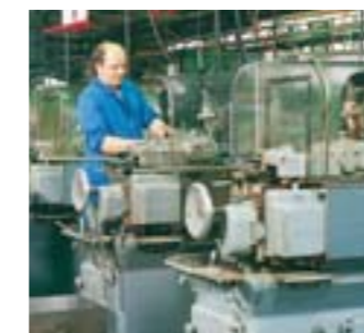
Was nicht mehr jeder kann: Wirtschaftliche Produktion mittlerer und großer Serien auf Kurvendrehautomaten
